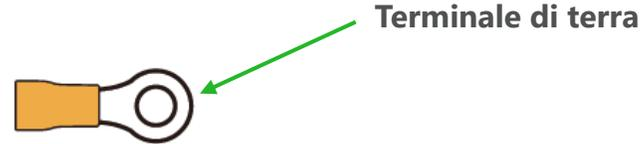
**2** Fissare il filo PE giallo-verde al foro di terra sul lato destro dell'inverter con le viti, assicurandosi che il terminale PE sia correttamente collegato a terra.
